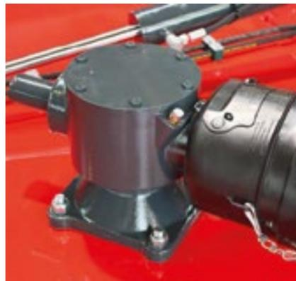
Boîtier de rotor - avec reniflard - puissance admissible de 180 ch - contenance d'huile: 3,5 litres
