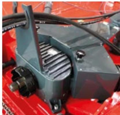
Boîtier diviseur - avec reniflard - puissance admissible de 290 ch - contenance d'huile: 3,8 litres
