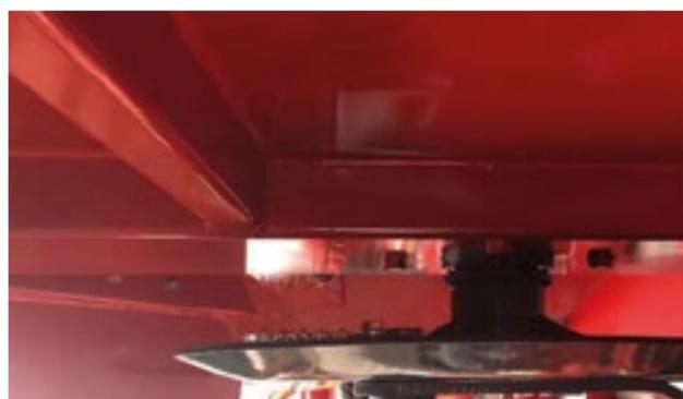
Grand dégagement et construction tubulaire apparente sous un châssis pour une meilleure performance du système de coupe et un meilleur broyage.
