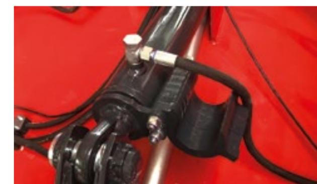
Réglage de la hauteur de coupe s'effectue sur chaque vérin, à l'aide cales d'épaisseur: un vérin sur le châssis central et un vérin pour chaque aile.
