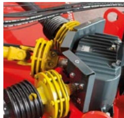
Sécurité à friction, avec 2 disques sur chaque cardan secondaire
