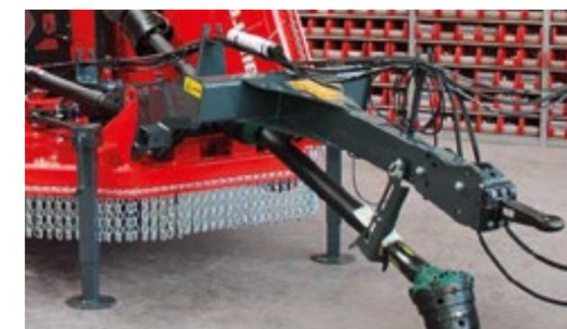
La flèche peut être montée au dessus ou en dessous du cardan, en fonction du choix de l'utilisateur.
