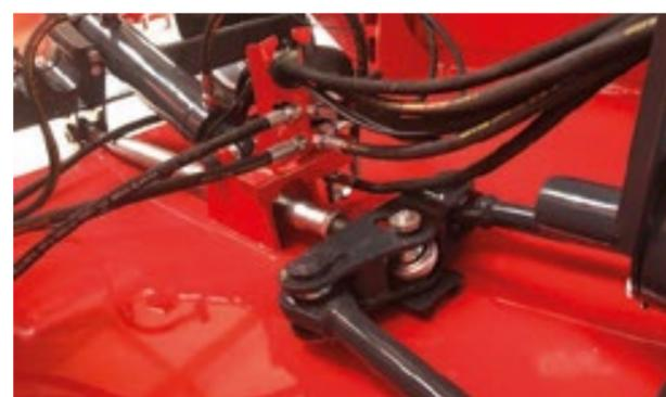
Réglage de l'assiette par un système de tirants reliant le train roulant et la flèche. Le système est identique à celui d'un troisième point.
